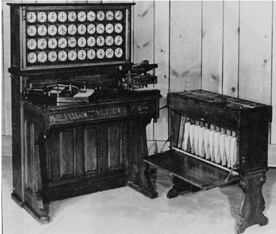
Kuva 4: Vuoden 1890 väestönlaskennassa käytetty reikäkorttikone
