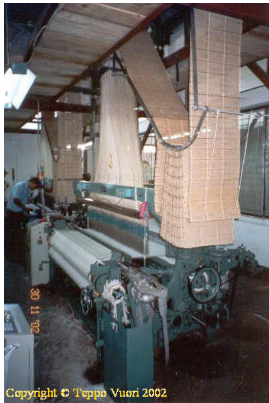
Kuva 10. Sähkökäyttöinen kutomakone [Vuo02]
