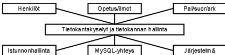
Kuva 5: Tietokantakyselyt ja tietokannan hallinta -kerroksen moduulijako.
