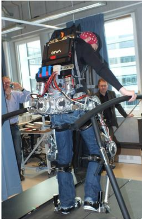
Kuva 4: Aivokäyttöliittymällä ohjattava vartaloproteesi [Exo12].
